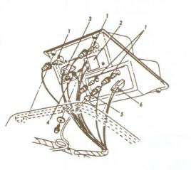
1. CLUSTER LIGHT 2. BATTERY GAUGE CONNECTION 3. TEMPERATURE GAUGE CONNECTION 4. GAUGE CLUSTER GROUND 5. OHL PRESSURE GAUGE CONNECTION 6. FUEL GAUGE CONNECTION
